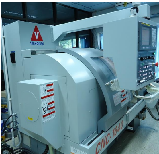
รูปที่ 3.4 เครื่องกลึงระบบอัตโนมัติ (CNC Turning)
