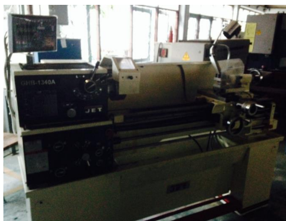
รูปที่ 3.3 เครื่องกลึงสำหรับเตรียมชิ้นงานเชื่อม
