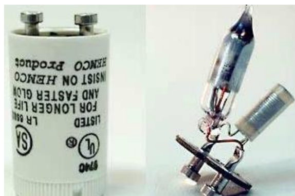
ภาพ 4 สตาร์ทเตอร์และส่วนประกอบสตาร์ทเตอร์
