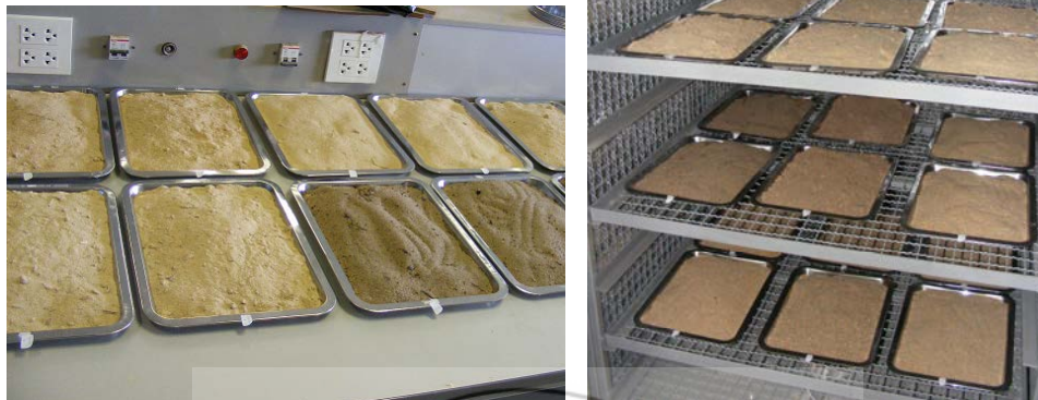
ภาพที่ 3.12 ตัวอย่างทรายชายหาดที่ตากไว้ ณ ที่อุณหภูมิห้อง และนำไปอบไล่ความชื้น
