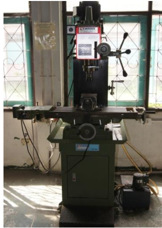
รูปที่ 3.3 แสดงเครื่องเจาะแนวตั้ง รุ่น VERTEX
