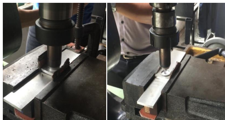
(จ) บ่า Tool จมลงในชิ้นงาน (ฉ) ยก Tool ขึ้นจากชิ้นงาน
