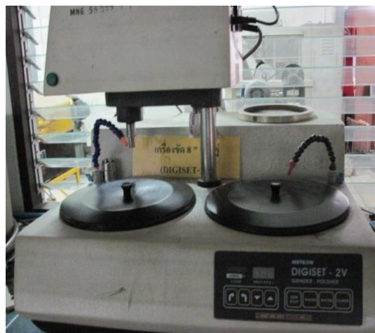
รูปที่ 3.6 เครื่องขัดกระดาษทรายและขัดสักหลาด
