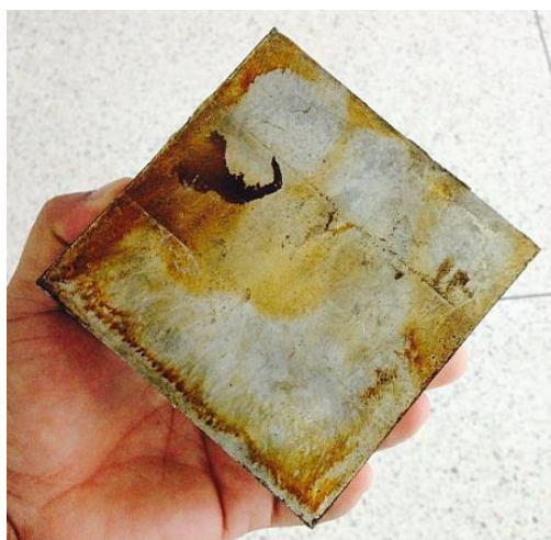
รูปที่ 3.2 อะลูมิเนียมหล่อกึ่งของแข็ง SSM7075
