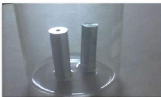
รูปที่ 3.13 ล้างผิวชิ้นงานด้วยน้ำยาอะซิโตน
