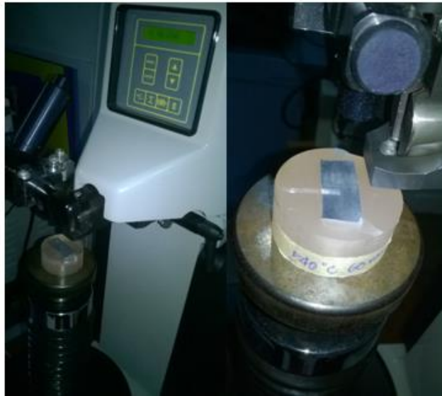
รูปที่ 3.16 ทดสอบความแข็งแรงด้วยเครื่องทดสอบแบบวิกเกอร์ส
