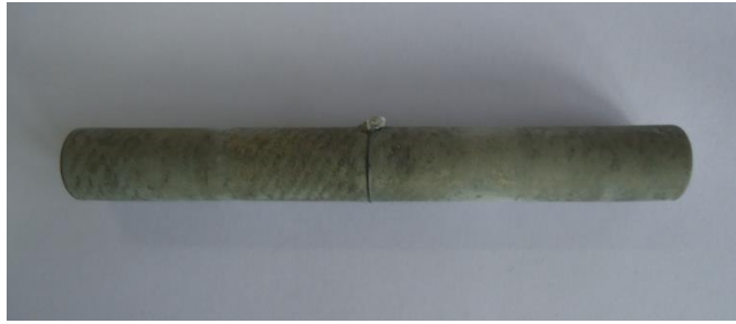
รูปที่ 4.2 ชิ้นงานเชื่อมที่อุณหภูมิ 480 องศาเซลเซียส เวลาในการเชื่อม 60 นาที
