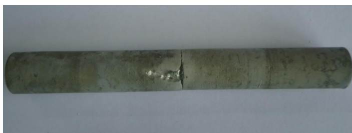
รูปที่ 4.7 ชิ้นงานเชื่อมที่อุณหภูมิ 540 องศาเซลเซียส เวลาในการเชื่อม 90 นาที
