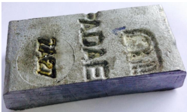
รูปที่ 3.3 สังกะสี-อะลูมิเนียม เกรด ZA27
