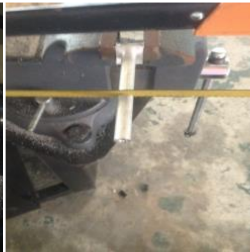
(ข) ตัดแบ่งชิ้นงานเป็น 2 ชิ้น
