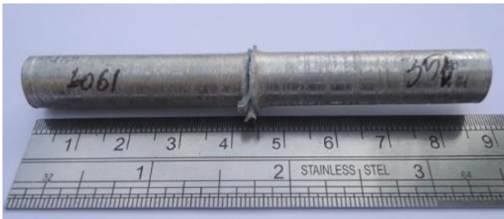
รูปที่ 4.5 ลักษณะของชิ้นงานที่ผ่านการเชื่อมเสียดทานที่ 1700 รอบต่อนาที ระยะกัดอัด 2.5 มิลลิเมตร
