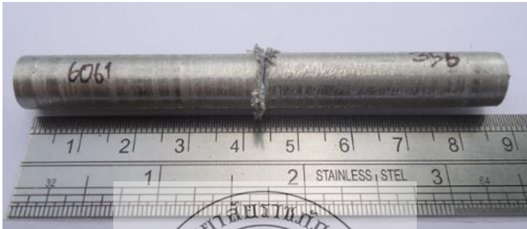
รูปที่ 4.7 ลักษณะของชิ้นงานที่ผ่านการเชื่อมเสียดทานที่ 1850 รอบต่อนาที ระยะกอดอัด 2 มิลลิเมตร
