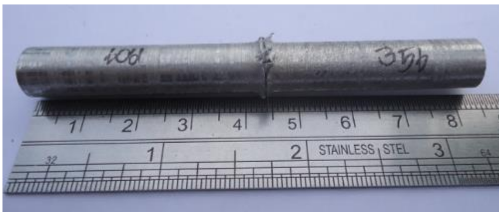
รูปที่ 4.2 ลักษณะของชิ้นงานที่ผ่านการเชื่อมเสียดทานที่ 1550 รอบต่อนาที ระยะกัดอัด 2.5 มิลลิเมตร
