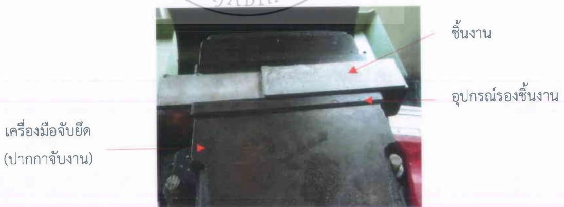
รูปที่ 3.12 ลักษณะการติดตั้งและปรับแต่งเครื่องมือในการเชื่อม
