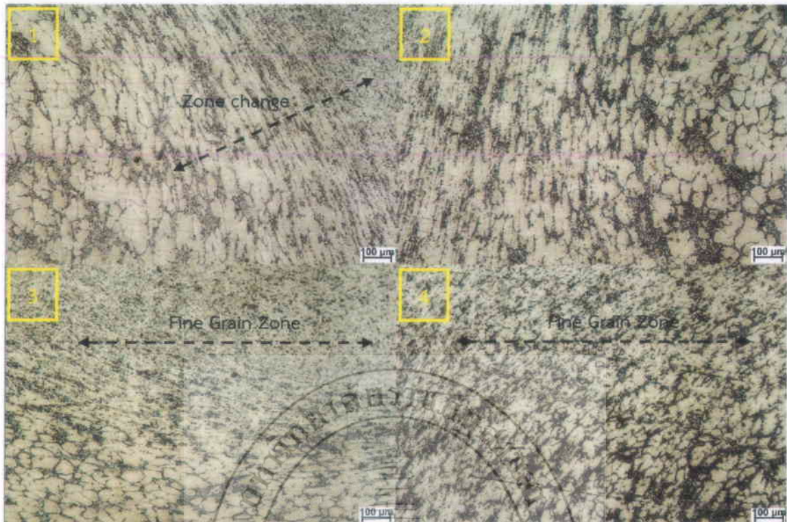
รูปที่ 4.12 ลักษณะโครงสร้างจุลภาคที่ระยะกดลึก 1.5 มิลลิเมตร เวลาในการกดแช่ 60 วินาที
