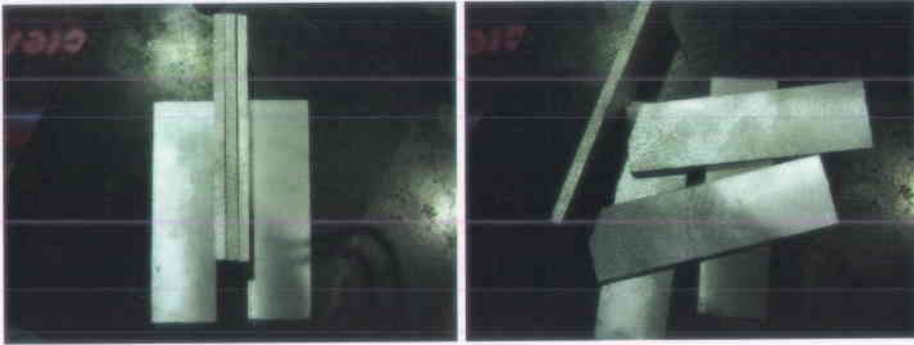
รูปที่ 3.11 ชิ้นงานสำเร็จที่พร้อมเชื่อมเสียดทานแบบจุด
