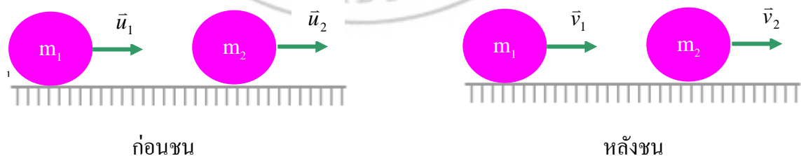
รูป 5.3 วัตถุ m_1 ชนวัตถุ m_2 ทำให้ความเร็วเปลี่ยนแปลง
