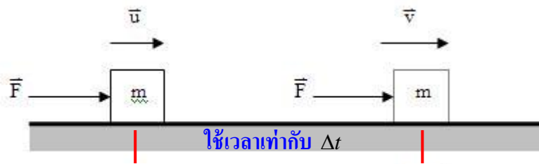
รูป 2.1 แรงคงตัว \vec{F} กระทำต่อมวล m ในเวลา \Delta t
