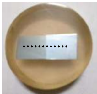
รูปที่ 3.22 ชิ้นงานบริเวณพื้นที่กหนดค่าความแข็ง
