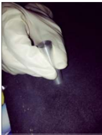
รูปที่ 3.13 ขัดชิ้นงานด้วยกระดาษทรายเพื่อกำจัดฟิล์มออกไซด์
