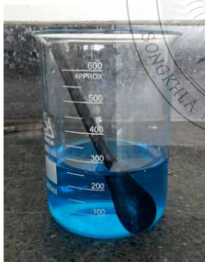
รูปที่ 2.11 ลักษณะการทดสอบการย่อยสลายสารละลายเมทิลีนบลู
