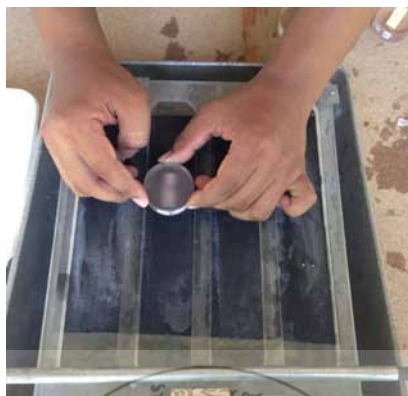
ภาพที่ 3.19 แสดงขัดชิ้นงานด้วยกระดาษทราย
