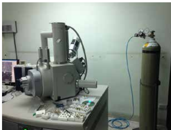
ภาพที่ 3.11 แสดงกล้องอิเล็กตรอนแบบส่องกราด ยี่ห้อ FEI-Quanta รุ่น 400
