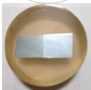
ภาพที่ 3.20 แสดงลักษณะของชิ้นงานที่พร้อมตรวจสอบโครงสร้างทางโลหะวิทยา
