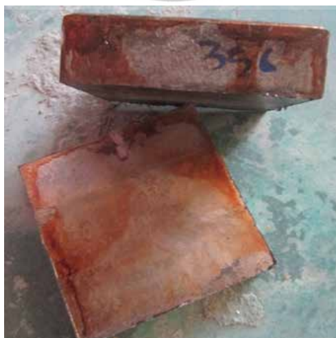
ภาพที่ 3.2 แสดงอะลูมิเนียมหล่อกึ่งของแข็ง SSM 356 ที่ได้จากการหล่อขึ้นรูปแบบ GISS
