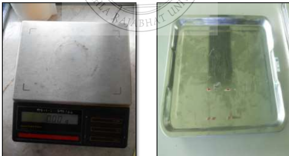
ภาพที่ 3.2 เครื่องชั่งสารและกะบะตากตัวอย่างทรายชายหาด
