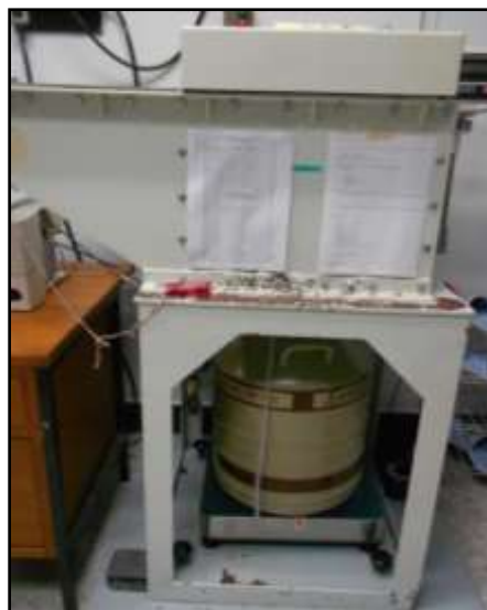
ภาพที่ 3.9 การปิดผนึกกระปุกพลาสติกด้วยเทปกาวและหัววัดรังสีแบบเจอร์มาเนียมบริสุทธิ์สูง และระบบวิเคราะห์แบบแกมมาสเปกโตรเมตรี
