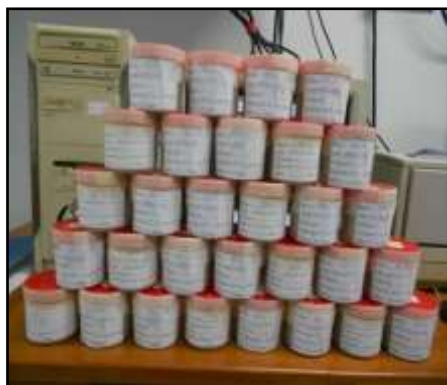
ภาพที่ 3.9 การปิดผนึกกระปุกพลาสติกด้วยเทปกาวและหัววัดรังสีแบบเจอร์มาเนียมบริสุทธิ์สูง และระบบวิเคราะห์แบบแกมมาสเปกโตรเมตรี
