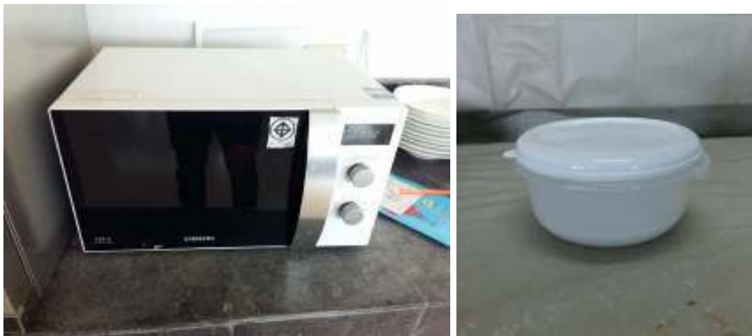
รูปที่ 2.5 การรีฟลักซ์ด้วยเตาไมโครเวฟ
