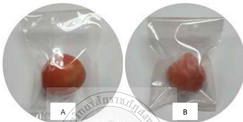
รูปที่ 2.13 การทดสอบการยืดอายุการเก็บรักษามะเขือเทศ โดย (A) ผลมะเขือเทศห่อด้วยถุงพลาสติกที่ไม่มีสารเคลือบ และ (B) ผลมะเขือเทศห่อด้วยถุงพลาสติกที่มีสารเคลือบ
