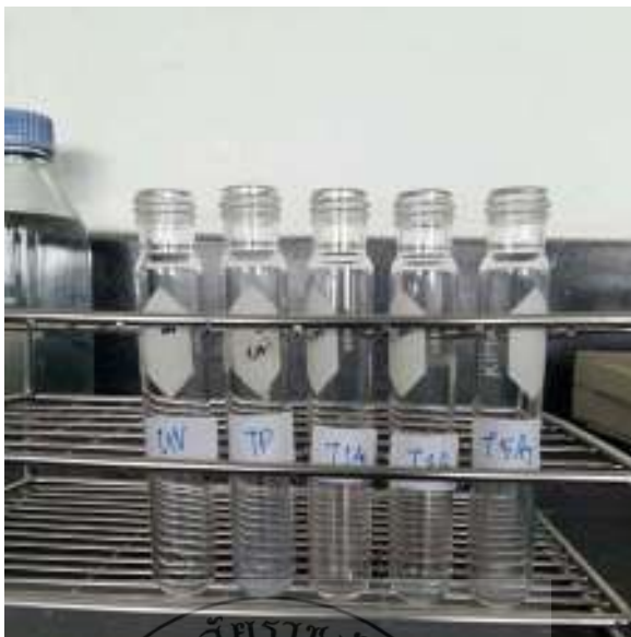
รูปที่ 2.9 ลักษณะการวางชิ้นงานก่อนทดสอบการย่อยสลายสารละลายเมทิลีนบลู
