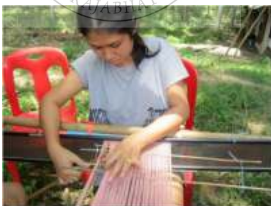
ภาพที่ 2.16 การตัดเส้นด้ายก่อนเตรียมเก็บตะกอก
