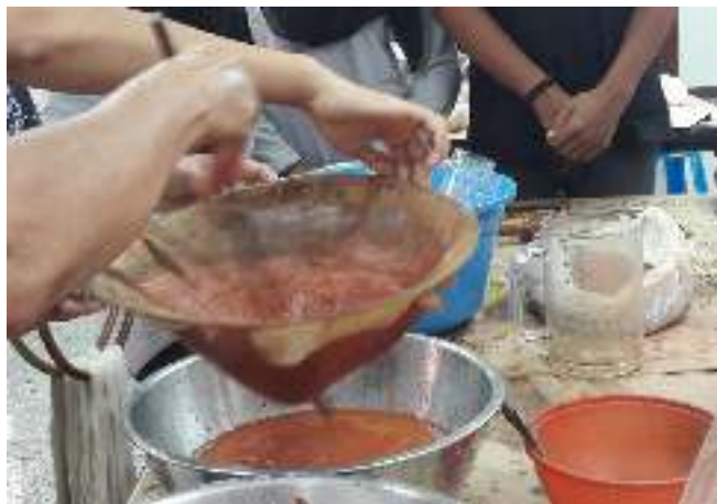
ภาพที่ 2.4 หินลูกรังที่บดแล้วนำมากรองกับตะแกรง
