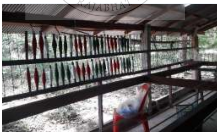
ภาพที่ 2.12 การหมุนเข้าหลอดเตรียมเดินด้าย
