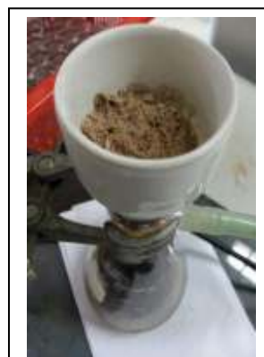
ภาพที่ 3.1 ตะกอน และการกรองตะกอนด้วยกรวยบู้กเนอร์
