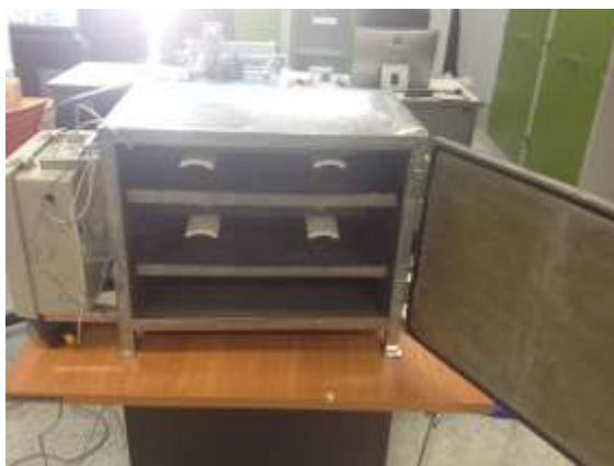
รูปที่ 4.2 และ 4.3 แสดงลักษณะภายใน และภายนอก ของตู้อบอินฟราเรด
