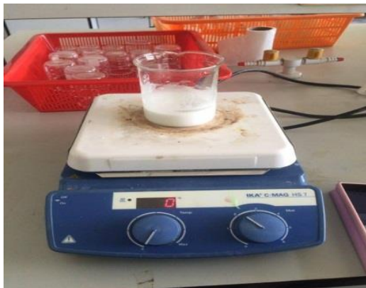
(ซ) ละลายเถ้าเปลือกหอยแครงความ เข้มข้น 20 30 40 กรัม/100 ml ด้วย
