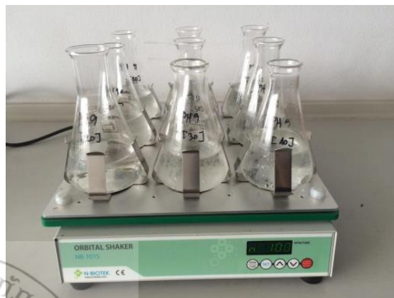
(ข) นำเข้าเครื่องเขย่าด้วยความเร็วรอบ 100 รอบ
