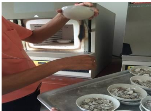
(จ) เเผาด้วยเตา BURN ด้วยความร้อน 800 °c เป็นเวลา 2 ชั่วโมงตั้งเต้าให้เย็นก่อนนำเข้าเครื่องตุความชื้น
