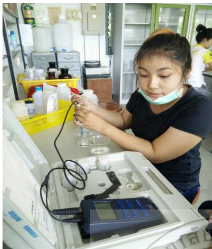
(ก) การปรับพีเอชของน้ำเสียสังเคราะห์
