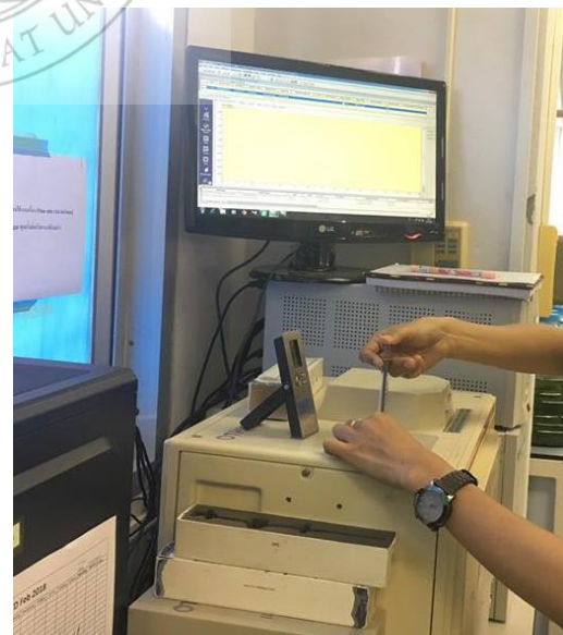
วิเคราะห์ห้องค์ประกอบของก๊าซ ( \text{CH}_4 , \text{CO}_2 , และ \text{N}_2 ) โดยใช้เครื่อง GC-TCD
