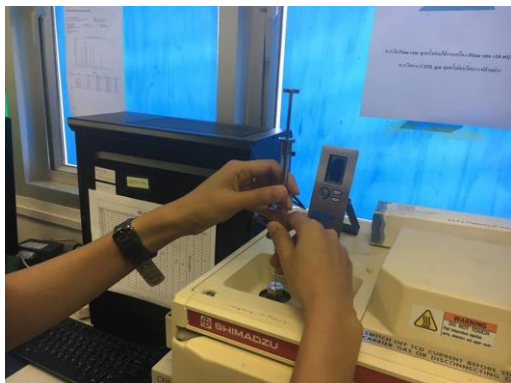
วิเคราะห์ห้องค์ประกอบของก๊าซ ( \text{CH}_4 , \text{CO}_2 , และ \text{N}_2 ) โดยใช้เครื่อง GC-TCD
