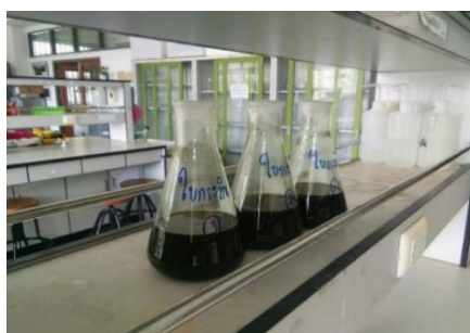
ภาพที่ 3.5-1 การแช่ใบกระฉินและใบยาสูบ (พันธุ์พื้นเมืองสงขลา) ในเอทานอลร้อยละ 95
