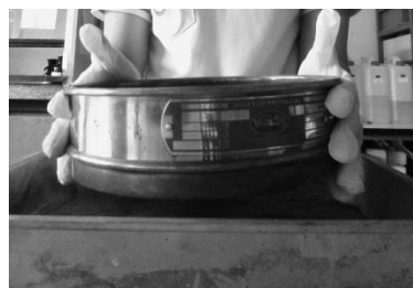
ภาพการทำผงโดยร่อนผ่านตะแกรงขนาด 1 มิลลิเมตร
