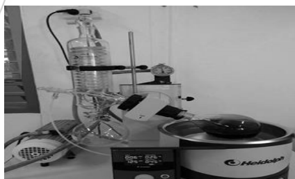
ภาพการระเหยเอทานอลโดยใช้เครื่องระเหยสุญญากาศ
