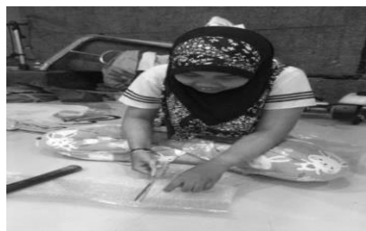
ภาพการตัดแผ่นตะแกรงขนาดตา 0.4 มิลลิเมตร ขนาดเท่ากับ 12×12 เซนติเมตร
