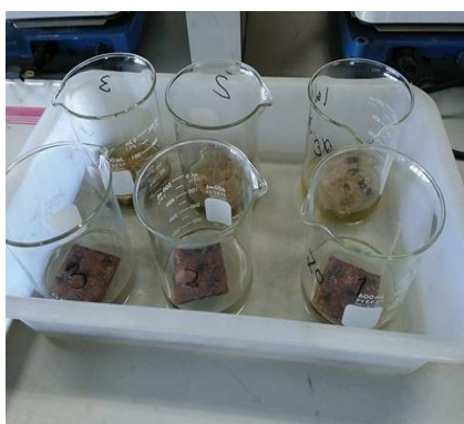
(ก) นำชิ้นทดสอบแช่ในน้ำกลั่น 20 \pm 2 °C
