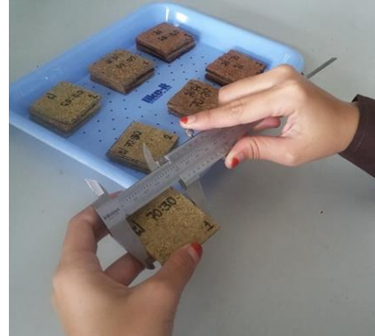
(ข) วัดขนาดความกว้างและความยาวของชิ้น ทดสอบ แล้วนำมาชั่งน้ำหนักก่อนทดสอบ
