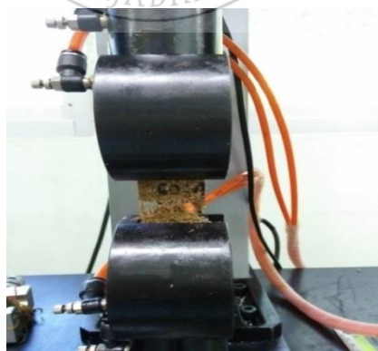
การทดสอบความต้านแรงดึงตั้งขนานกับผิวหน้า
