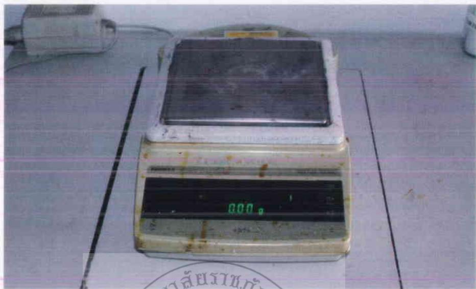
ภาพที่ ฉ-3 เครื่องซั่งไฟฟ้าทศนิยม 2 ตำแหน่ง
