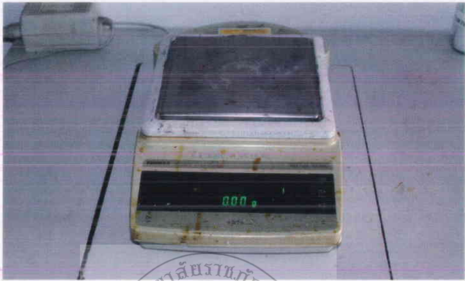
ภาพที่ ฉ-3 เครื่องชั่งไฟฟ้าทศนิยม 2 ตำแหน่ง
