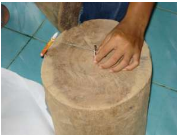
(ภาพประกอบที่ 6 การปักหมุดกำหนดจุดกึ่งกลางของหุ่นกลองดาระ)
