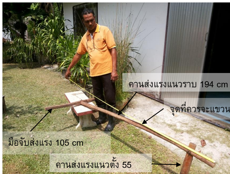
รูป 3.12 ชุดคานส่งแรง ประกอบด้วย 3 ส่วนคือ มือจับ คานส่งแรงตามแนวราบ และคานส่งแรงตามแนวตั้ง
