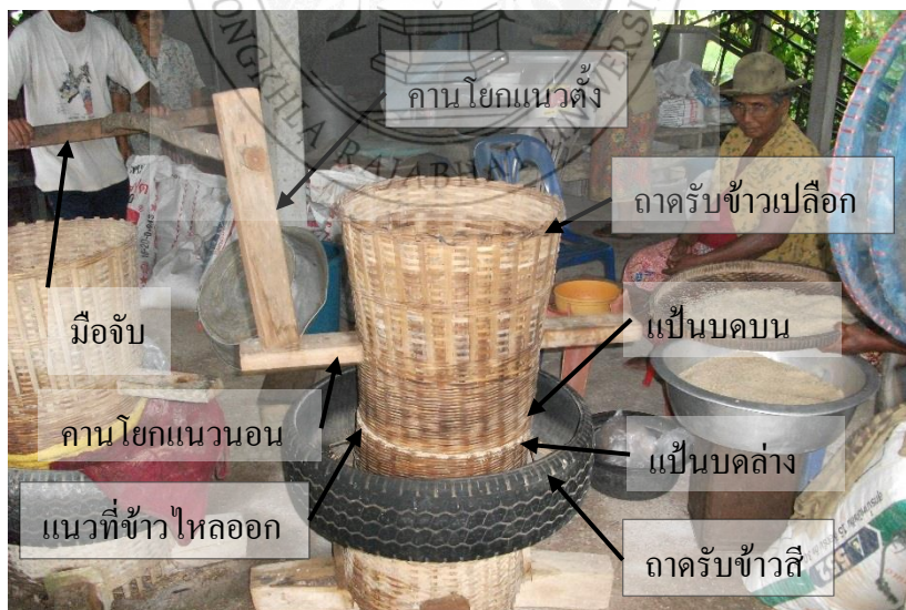
รูป 2.8 แสดงครกสีแบบหมุนของกลุ่มแม่บ้านควนคง ซึ่งมีถาดทรงกระบอกสำหรับใส่ข้าวเปลือกอยู่ด้านบนสุด
