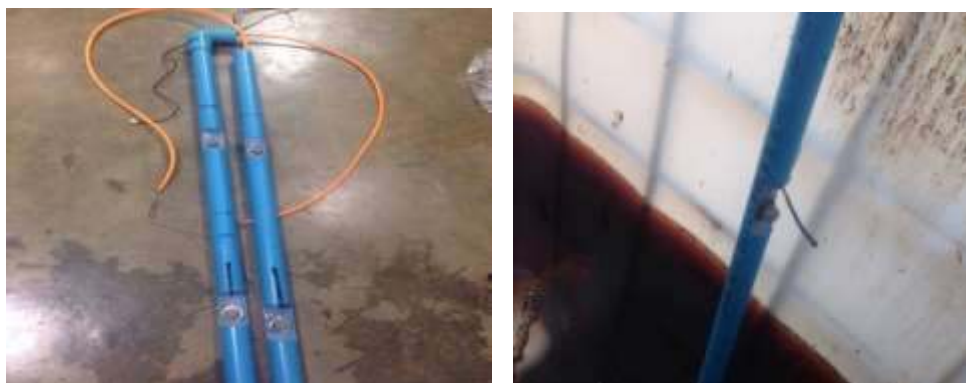
ภาพที่ 3-21 การติดตั้งชุด โมดูลตรวจวัดก๊าซมีเทน ZX-MQ5 ภายในถังหมักก๊าซชีวภาพ
