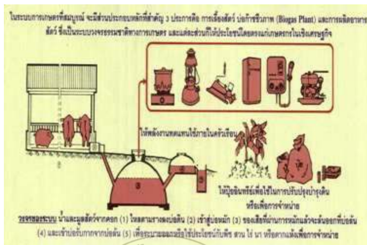
ภาพที่ 2-1 ขั้นตอนการผลิตก๊าซชีวภาพแบบพอยิ่งในครัวเรือน ที่มา : (กระทรวงพลังงาน, 2556)
