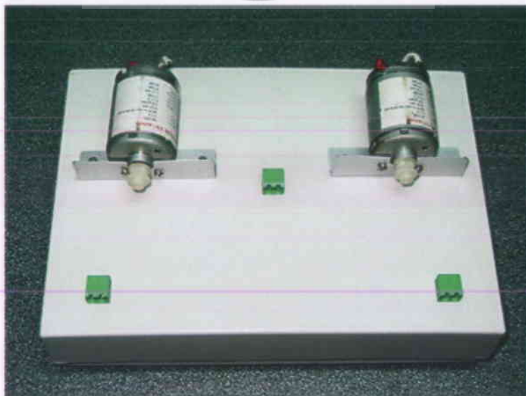
ภาพที่ 4-6 บอร์ดทดลองการควบคุมมอเตอร์
