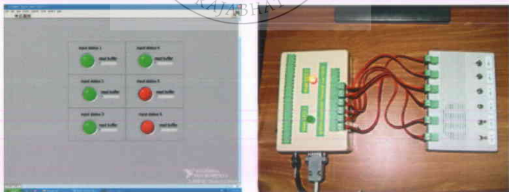
ภาพที่ ก-12 แสดงการทดสอบดิจิทัลอินพุตตัวที่ 4
