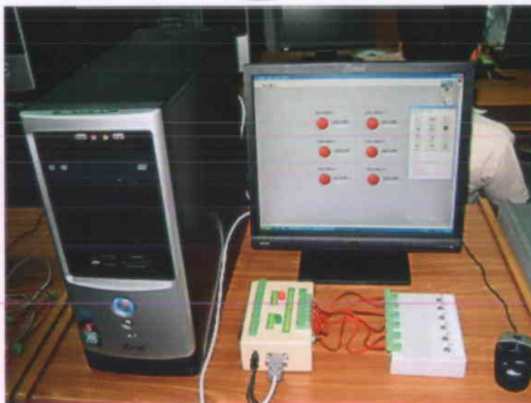
ภาพที่ ก-8 การต่อร่วมระหว่างคอมพิวเตอร์กับชุดอินเตอร์เฟสบอร์ดทดสอบดิจิทัลอินพุทสวิทช์
