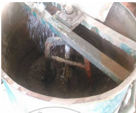
ภาพที่ 2.1-6 การผสมวัสดุผลิตอิฐบล็อกด้วยเครื่องโม่ผสมอัตโนมัติ
