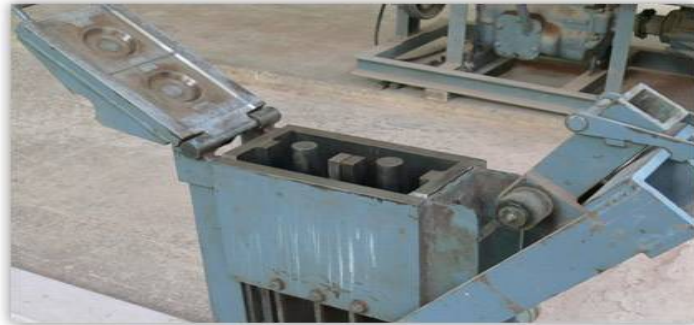
ภาพที่ 3 เครื่องอัดบล็อกประสานเครื่องอัดด้วยแรงคน
