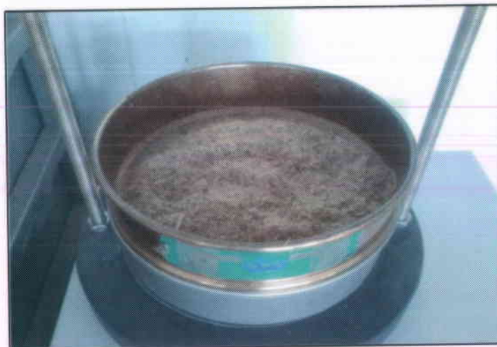
ภาพที่ 3.2 ร่อนด้วยตะแกรงร่อน ขนาด 1000 ไมครอน
