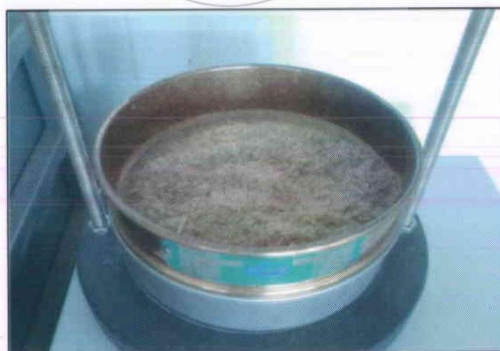
ภาพที่ 3.2 ร่อนด้วยตะแกรงร่อน ขนาด 1000 ไมครอน
