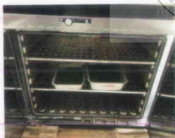
อบให้แห้งที่อุณหภูมิ 50 องศาเซลเซียส เป็นเวลา 2 วัน
