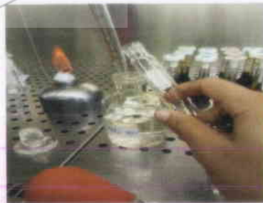
ปรับความเข้มข้นของเชื้อ ด้วย NaCl 0.85 %
