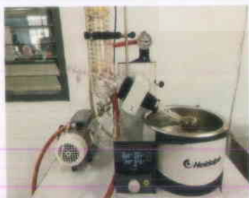
ระเหยเอทานอลออก โดยใช้เครื่อง Rotary evaporator
