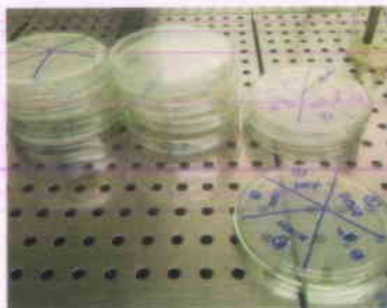
ทำเครื่องหมายที่จานเพาะเชื้อ แบ่งเป็น 5 ส่วนเท่าๆกัน
