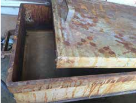
ภาพที่ 3.21 อ่างกรด ที่มา : บัณฑิตา วรศรี
