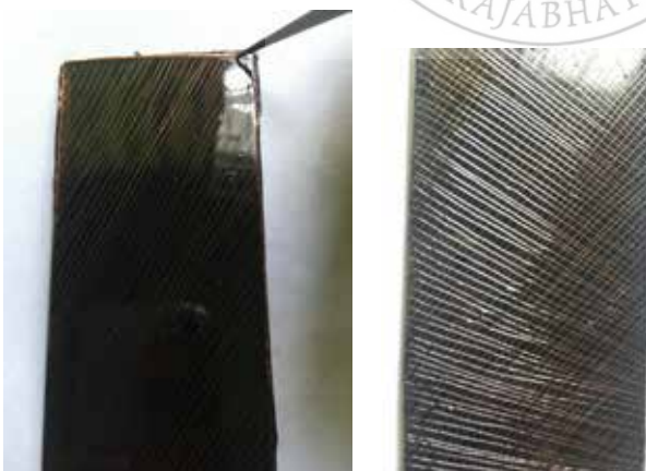
ภาพที่ 3.25 การขีดเส้นเพื่อทดลองกัดกรด ที่มา : บัณฑิตา วรศรี
