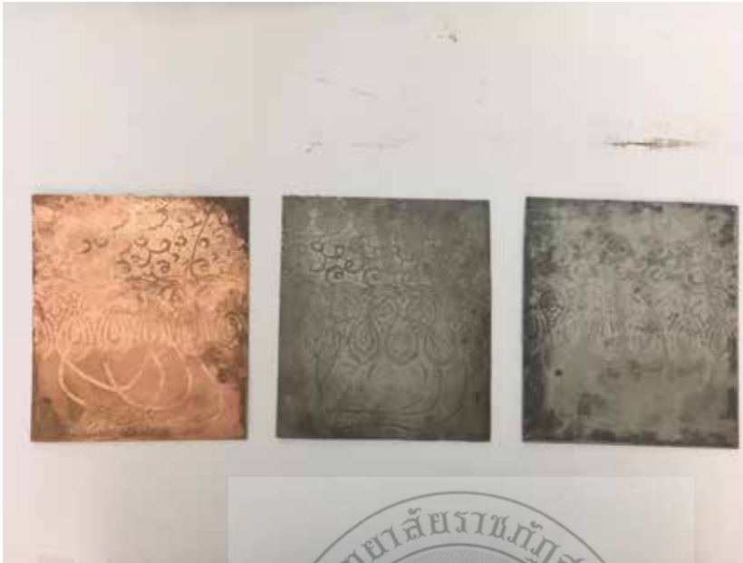
ภาพที่ 3.42 แม่พิมพ์หลังกัดกรดเสร็จ แผ่นทองแดง แผ่นเหล็กขาว แผ่นเหล็กดำ ที่มา : บัณฑิตา วรศรี
