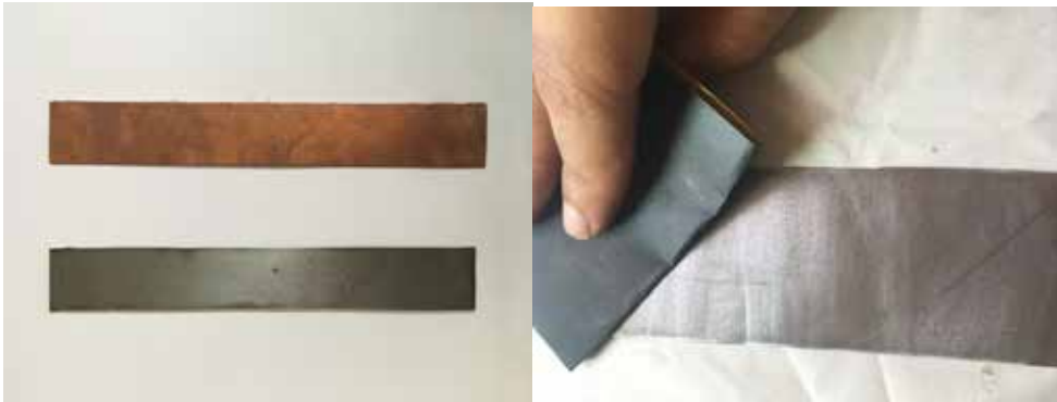
ภาพที่ 3.23 การเตรียมแผ่นแม่พิมพ์ ที่มา : บัณฑิตา วรศรี
