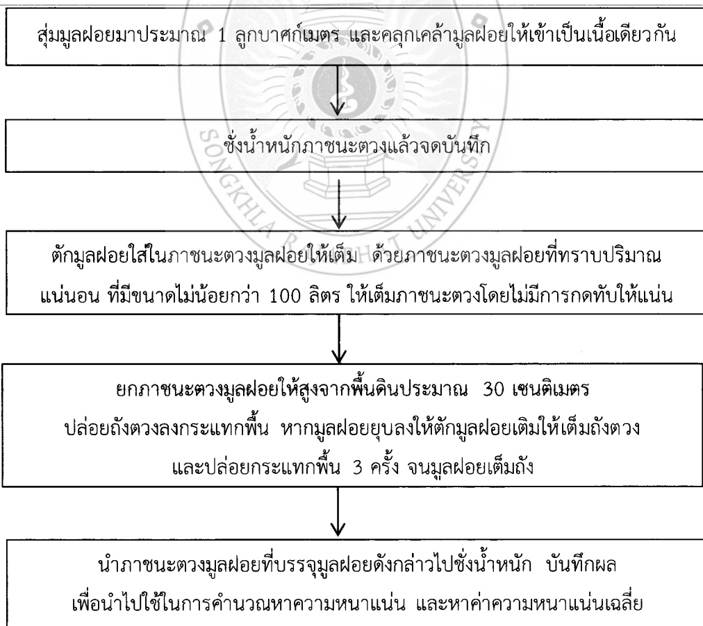
ภาพที่ 3.6 ขั้นตอนการหาความหนาแน่นของมูลฝอย
