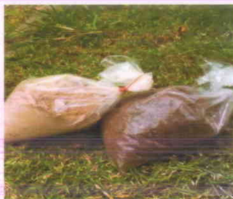
(ง) นำตัวอย่างดินที่ได้มาผสมให้เข้ากัน แล้วเก็บตัวอย่างดินใส่ในถุงพลาสติกประมาณ 0.5-1 กิโลกรัม
