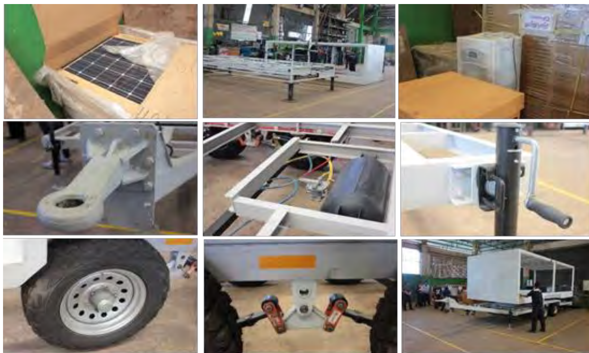
ภาพที่ 6-53 ชิ้นส่วนอุปกรณ์ประกอบ รถพลังงานไฟฟ้าสำหรับผลิตและใช้ไฟฟ้าด้วยเซลล์แสงอาทิตย์ต้นแบบ
