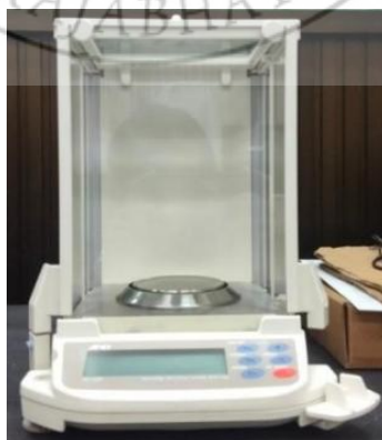
ภาพที่ 3.5 เครื่องชั่งน้ำหนักความละเอียดสูง รุ่น VERTEX CK-12B
