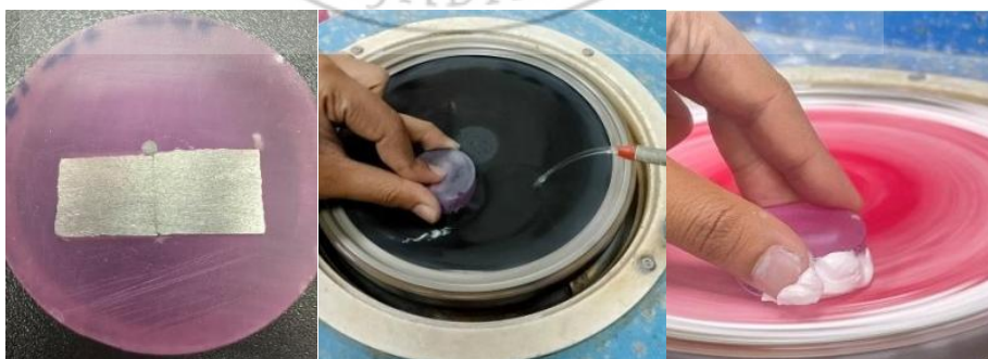
ภาพที่ 3.16 การขัดผิวให้เรียบด้วยกระดาษทราย
