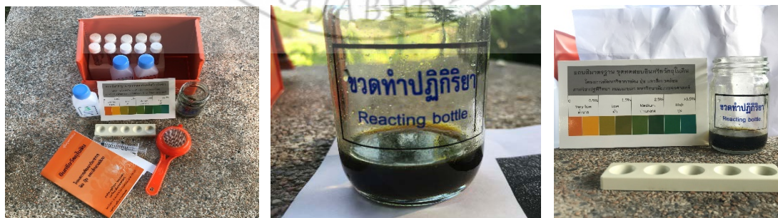
ภาพที่ 2 การทดสอบสมบัติของดินในแปลงปลูกข้าวโพด
