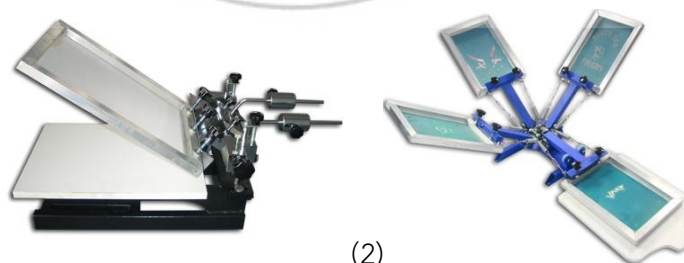
ภาพ 2.36 เครื่องพิมพ์ซิลค์สกรีนแบบ flatbed printing (1)แบบพิมพ์ 1 สี (2) แบบพิมพ์ 4 สี
