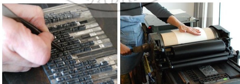
ภาพ 2.26 การเรียงตัวอักษรแม่พิมพ์โลหะและการพิมพ์ด้วยเครื่องพิมพ์ชนิดพลาเทน ที่มา: uclatoday. 2564. ออนไลน์
