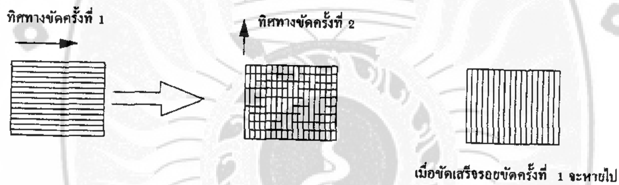
รูปที่ 2.10 ลักษณะแนวทางการขัดชิ้นตรวจสอบสลับเป็นตาราง
