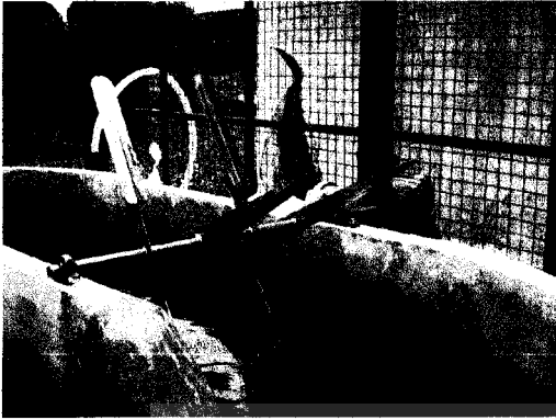
ภาพที่ 4-8 ใ้บพัดเติมอากาศในบ่อเพาะเลี้ยงสาหร่ายสไปรูไลนา
