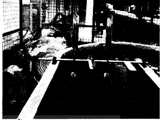
ภาพที่ 4-8 ใ้บพัดเติมอากาศในบ่อเพาะเลี้ยงสาหร่ายสไปรูไลนา
