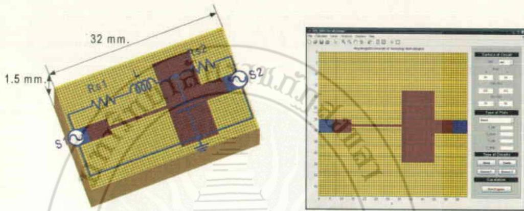
รูปที่ 5 วงจรกรองความถี่ต่ำและวงจรเทียบเคียง รูปที่ 6 การออกแบบวงจรกรองความถี่ต่ำผ่านไมโครสตริป
