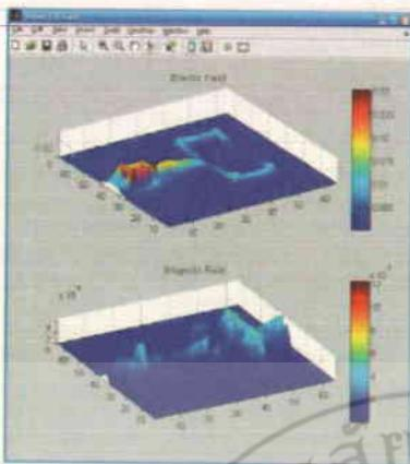
รูปที่ 9 การแพร่กระจายของค่าความถี่ 1.5 รูปที่ 10 การเปรียบเทียบค่าพารามิเตอร์กระแสจัดกระจาย GHz ที่เวลา  $5.97 \mu\text{s}$
