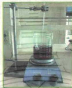
รูปที่ 2 การติดตั้งอุปกรณ์การสังเคราะห์ใบโอดีเซล
